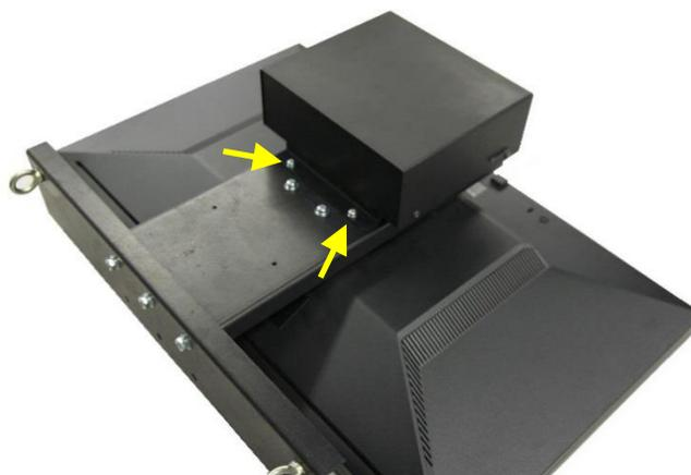
6. アイボルトを利用して吊り下げてください。施工時は安全・強度に注意してください。
