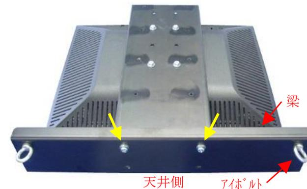
4. コントローラにブラケットをM4x8ネジにて取り付けてください。
