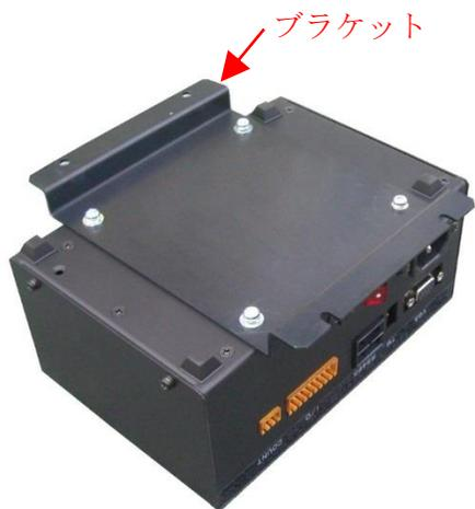
5. 柱にブラケットをM4x8ネジ(4個)にて取り付けてください。
