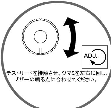
テストリードを接触させ、ツマミを左右に回し、ブザーの鳴る点に合わせてください。
