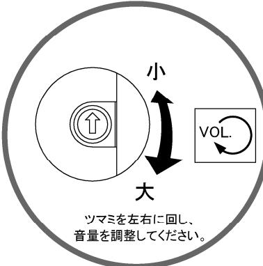
ツマミを左右に回し、音量を調整してください。
